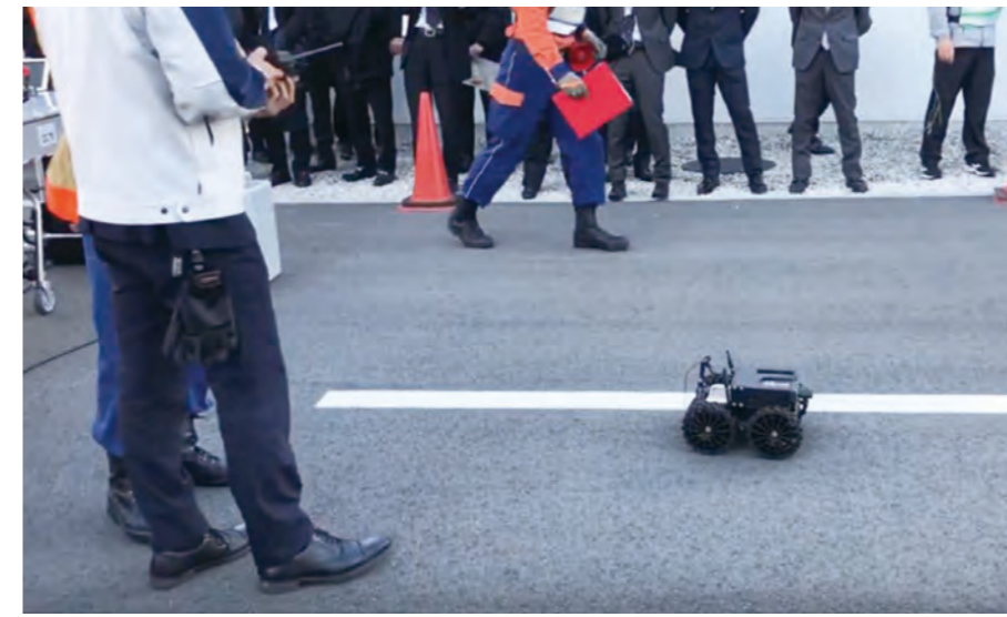
UGV：船山(株)が提供、操縦も担当。本事業では100kgまで運搬可能なイームズロボティクス社製を使用
