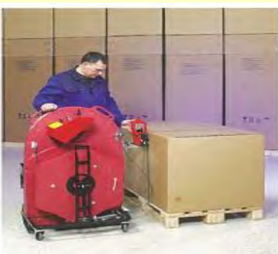
⑧バンドを結束機に挿入し、溶着する。 ※溶着は手動・自動から選択可能。
