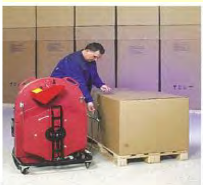
⑦リフターがバンドの反対側を持ち上げる。
